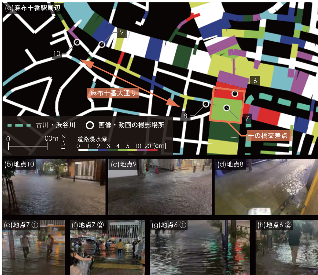
図3 麻布十番駅周辺の浸水深カウンター図および付近で撮影された SNS データ
