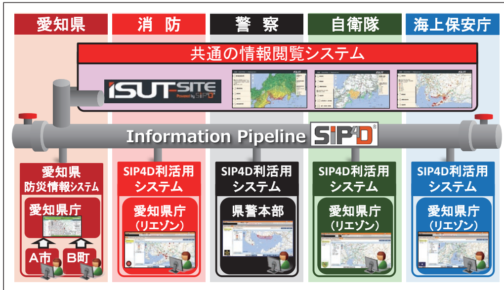
図4 災害情報の共有に関するシステム構成の概要
