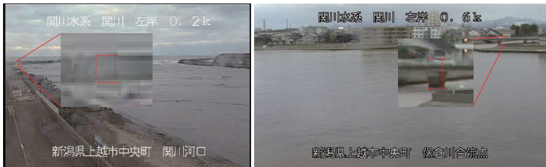
図10 津波高算定のための潮位検知枠 (左：関川河口，右：保倉川合流点)
