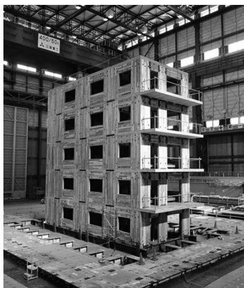
写真2 CLTによる5階建て振動台実験
