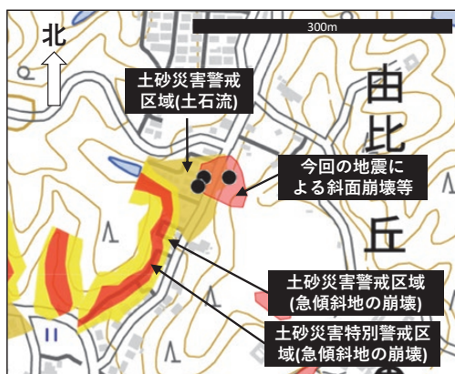
図8 斜面崩壊等の位置と土砂災害関係の災害リスク情報。土砂災害警戒区域、土石流危険溪流(本図範囲内には無し)、地すべり危険箇所(本図範囲内には無し)を表示。●は判読された倒壊等建物の位置。穴水町由比ヶ丘付近
