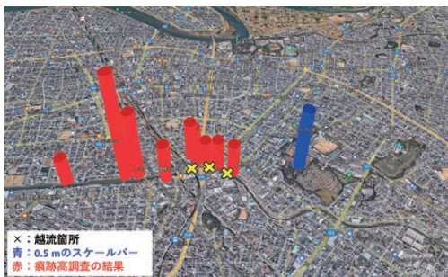
図6 柳生川における痕跡高調査の結果（青：0.5 mのスケールバー，×印：越水箇所） Google Earthの背景画像に描画
