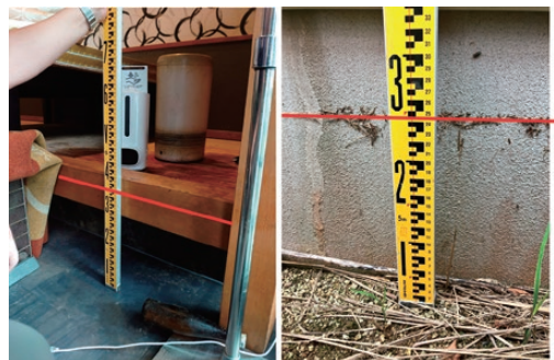
写真2 柳生川沿いの住宅敷地内における痕跡高調査の様子（水の到達点に赤線を追加） （左）飲食店内の浸水痕跡高，（右）越水地点周辺の住宅における浸水痕跡高
