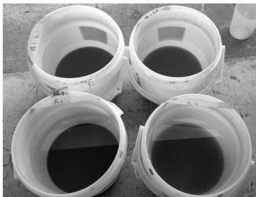
図4 浄水場沈殿池のスラッジ
