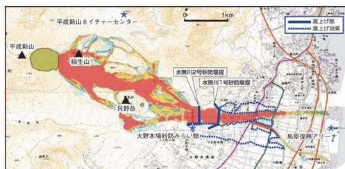
図2-3 ケース3崩壊による被害想定区域のイメージ(嵩上げ後)
