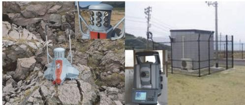
写真2-3 溶岩ドームに設置しているプリズム(左)と大野木場光波観測所(右)
