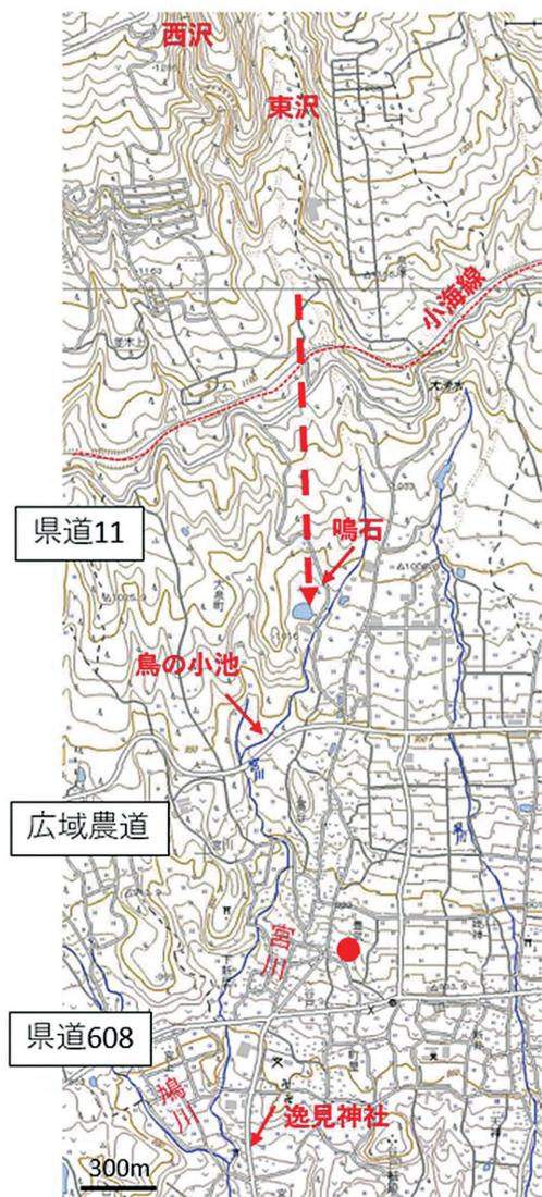
図3 明治31年9月大泉村土石流災害被災地周辺の地形図（地理院地図（2020年1月閲覧）に加筆）。JR小海線を赤破線で強調。赤丸は「鳴呼地水還身碑」の所在を示す。赤破線の矢印は、土石流の推定流路を示す。
