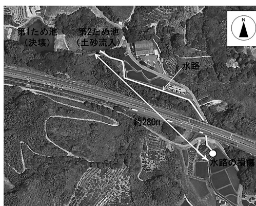
写真4 西分第1および第2ため池と下流水路との位置関係（空中写真出典：Google Earth）
