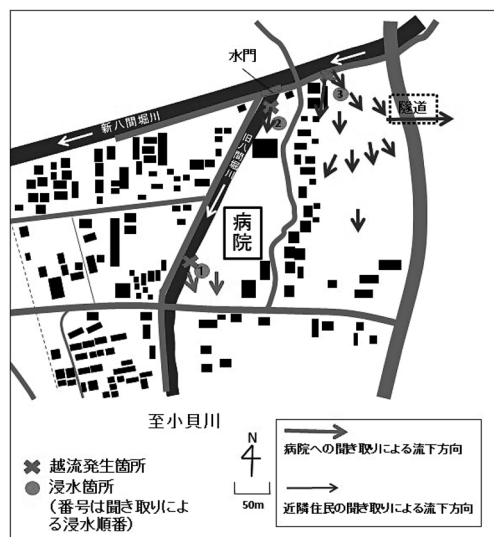
図6 八間堀川分派点付近の浸水状況
