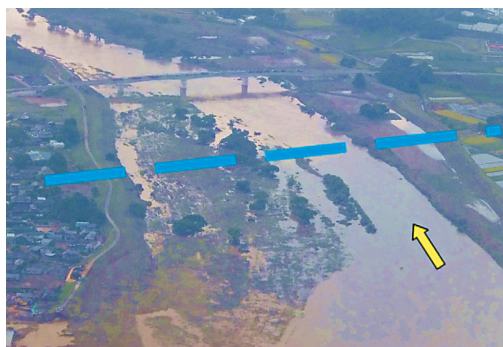
写真2 三坂町堤防決壊箇所の左岸下流に広がる砂州と樹林（ブルー鎖線は図5の横断面20.5k付近，2015.9.12執筆撮影）
