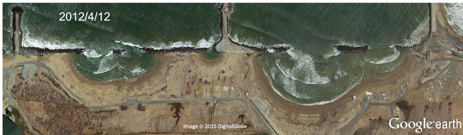
図5-5 汀線変動 (C 地点, 津波湾形成箇所, 2012年 4月12日)
