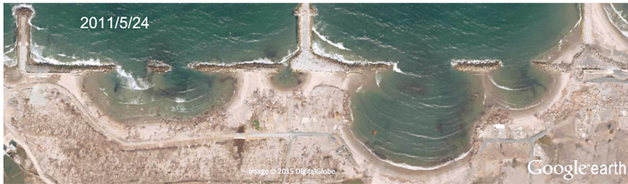
図5-4 汀線変動 (C 地点, 津波湾形成箇所, 2011年 5月24日)
