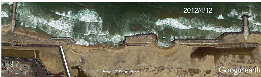
図4-5 汀線変動 (B 地点, 津波湾形成・非形成の混在箇所, 2012年 4月12日)
