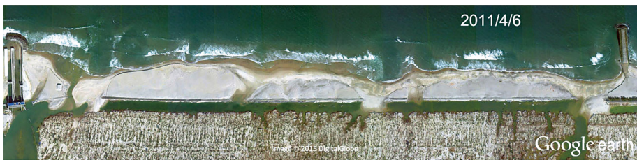
図3-3 汀線変動 (A 地点, 津波湾非形成箇所, 2011年4月6日)
