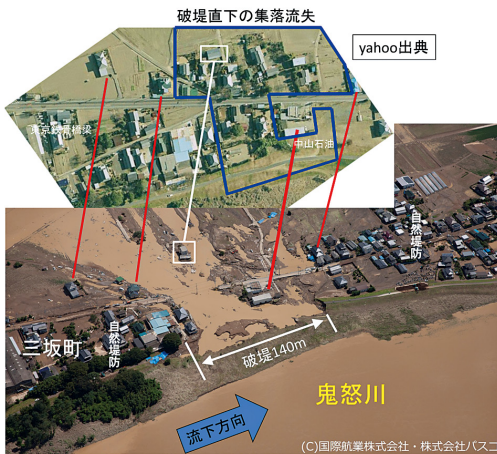
写真1 鬼怒川堤防の決壊と集落の流失(国際航業株式会社・株式会社パスコ, 2015; Yahoo, 2015)に加筆)
