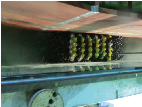
写真7 網式消波部材（8tタイプ）の整積み（図の左側より津波を作用させる）
