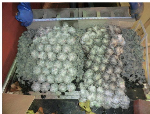
写真4 網式消波材模型の設置 (左側8tタイプ、右側6tタイプ。天端3列で2層積み)。
