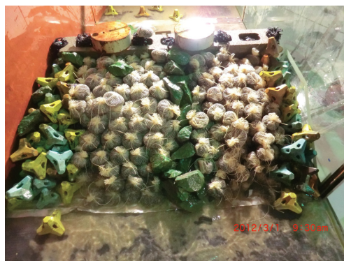
写真6 実験室内での最大津波による移動状況 (堤体への乗り上げが一部見える)
