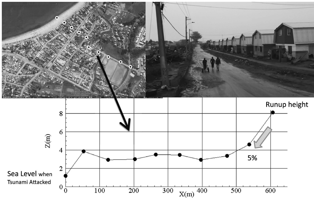
図5 Dichato での断面地形と津波遡上高さ (8.2m)
