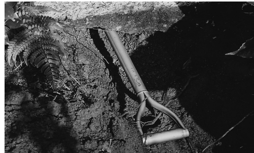
写真7 近見岩底面の状況 試掘により近見岩の底面が下部の岩体と分離していることが判明した
