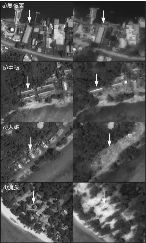
図4-6 津波による建物被害の目視判読例
