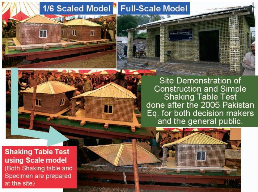
図9 現地での公開振動台実験の様子
