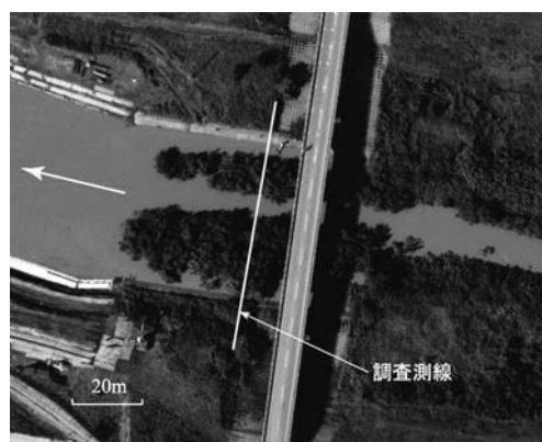
図4-1 美唄川における樹木群内外の流速測定箇所
