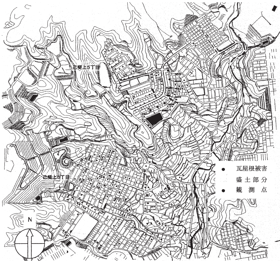
図1 広島市西区己斐上地区の木造瓦屋根被害箇所と切土・盛土、常時微動観測点
