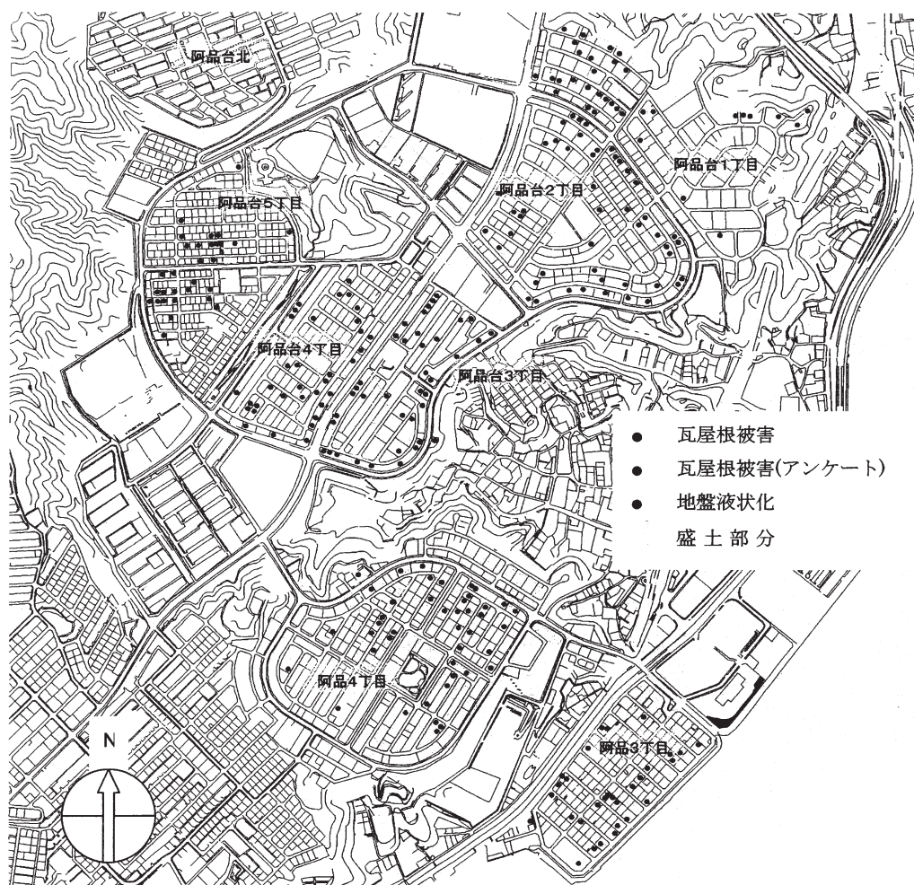
図2 廿日市市阿品台・阿品地区の木造瓦屋根被害箇所と切土・盛土
